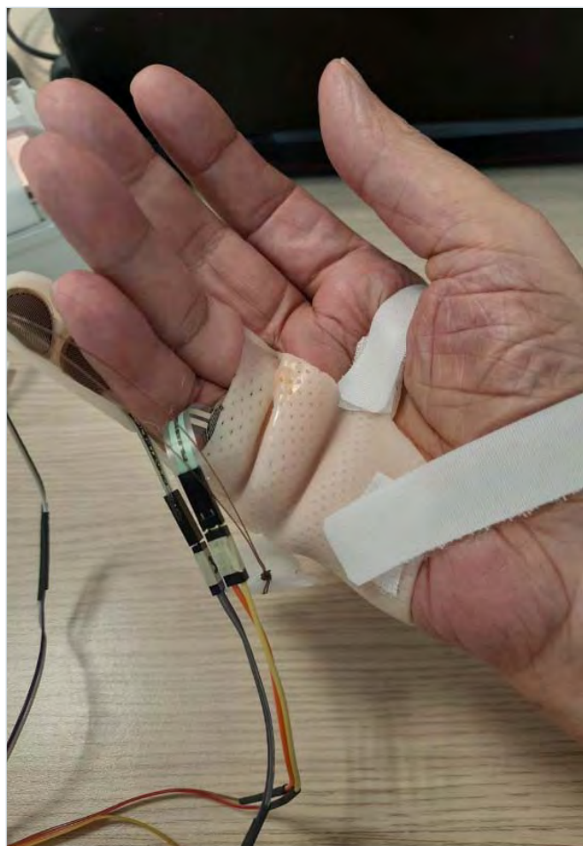
Figura 2. L'immagine mostra il sistema di trazione con una barra dorsale semirigida alla quale sono fissati i due sensori.
